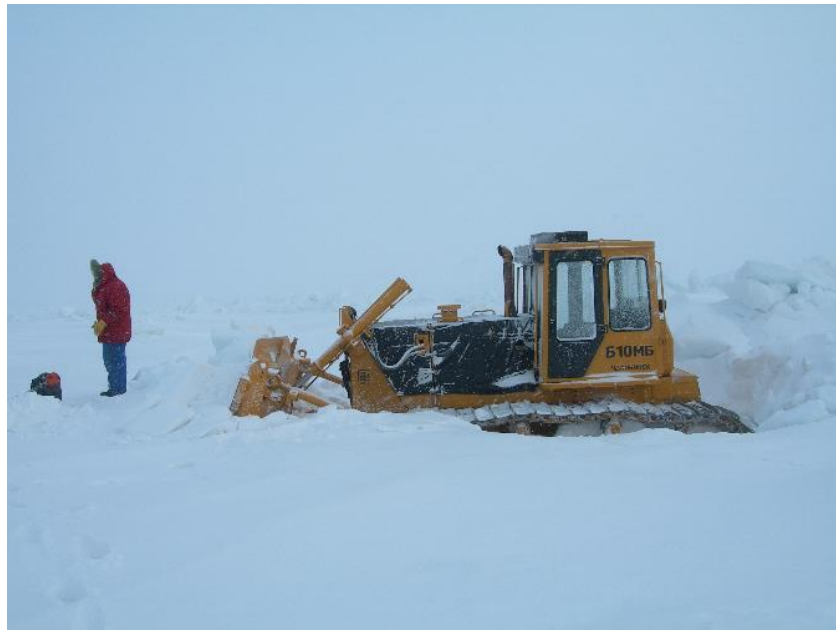
Бульдозер, свалившийся с тороса и подломивший лед
