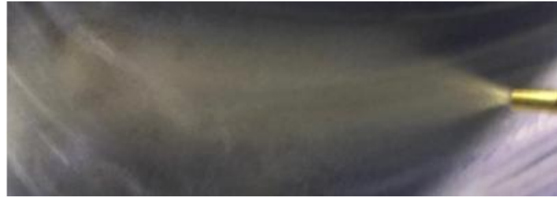
Факел распыла эмульсионной форсунки со шнеками ( \beta=75^\circ )
