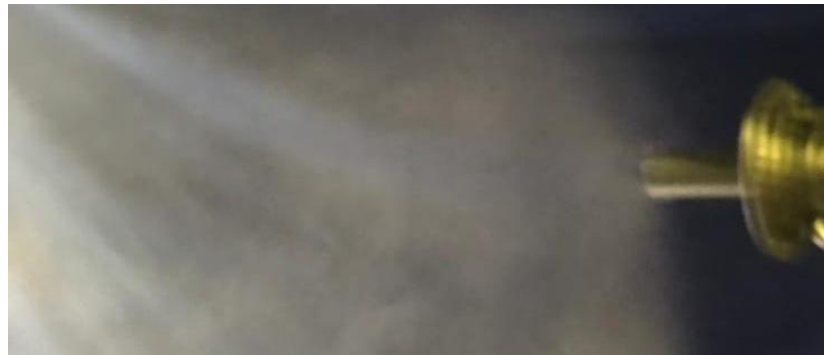
Факел распыла эмульсионной форсунки со шнеками ( \beta=35^\circ )
