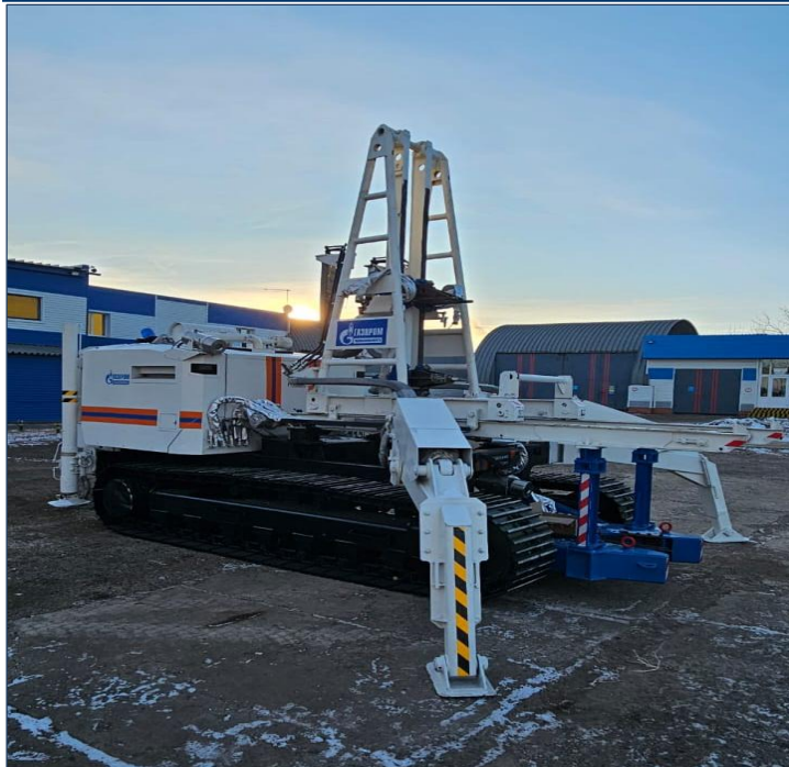
Универсальное подъемно – транспортное оборудование на гусеничном ходу УПТО РОИН 200-04 РТП-ГШ (робот)
